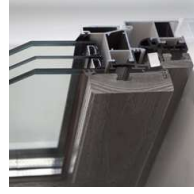
versione con vetro triplo canalina warm edge con gas argon di serie
